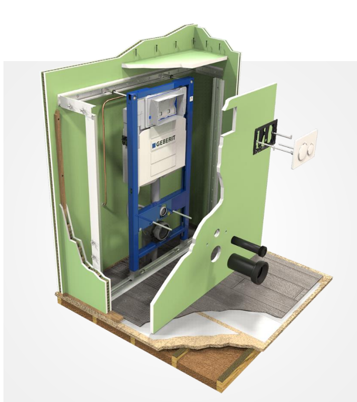
Sur sol plancher aggloméré et parquet flottant en applique sur cloison alvéolaire
